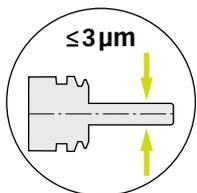
在3 x D处，系统整体径向跳动精度TIR ≤ 3 µm。
