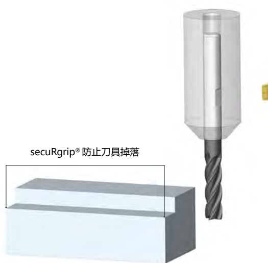
通过使用REGO-FIX secuRgrip®防止工件受损。
