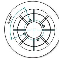
所有ER-CB夹头上4个冷却孔的直径均为为1.5mm
