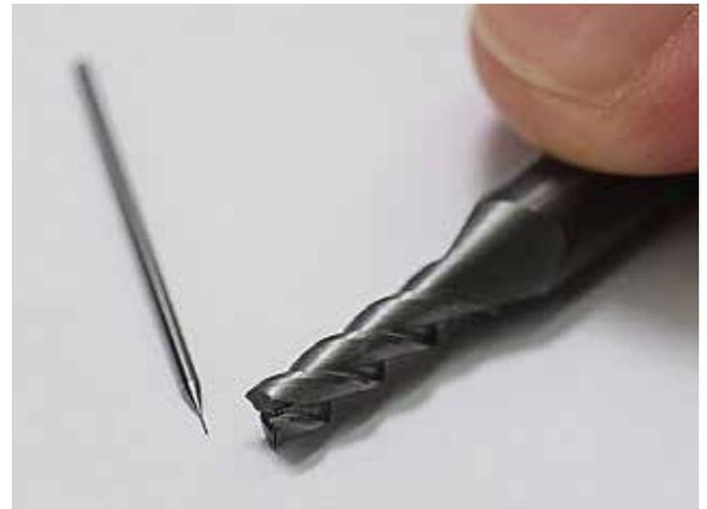
Spannungsarmes Aluminium (Nahaufnahme mit Mikrowerkzeug). Zerspanwerkzeug 0,15 mm Durchmesser.
