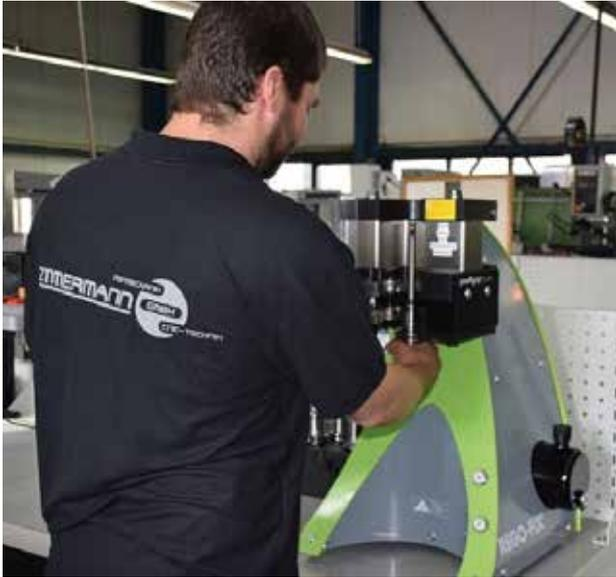
powRgrip System: Einzigartiges Werkzeugspannsystem, welches Werkzeuge per Knopfdruck und ohne Erwärmen in Sekundenschnelle einspannt und auch bei kleinsten Werkzeugdurchmessern einen nachhaltig präzisen Rundlauf aufweist.
